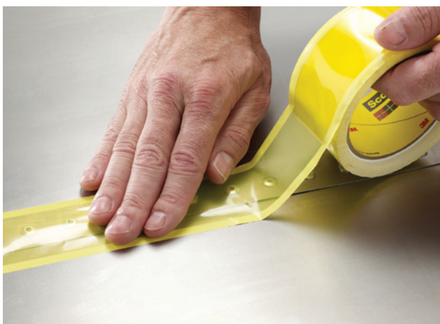
Taśmy 3M do nitowania utrzymują nity na miejscu i zapewniają ich widoczność w trakcie klasycznego procesu nitowania, bez niebezpieczeństwa przeniesienia kleju na łby nitów.
