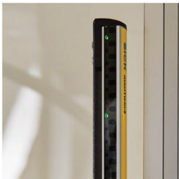
Bariery ochronne zatrzymujące automatycznie pracę maszyny
