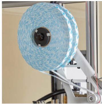
Geteilte Spindel zum Anbringen von zwei Bandrollen auf demselben Applikator
