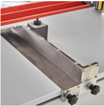
Doppelte magnetische Einzugsführungen für die Ausrichtung des Blatteinzugs
